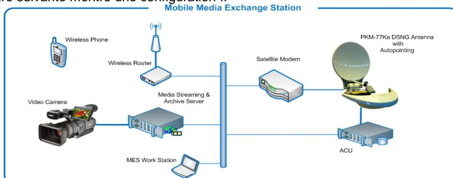
typique pour une Vidéo / Broadcast de contribution. Les systèmes sont livrés avec un ACU-350 en standard, qui permet de contrôler le système localement ou à distance grâce à un soft très convivial basé sur Windows Media System logiciel de contrôle (option). Ce système auto pointant (One Touch) facilite le fonctionnement quotidien dans toutes les conditions et d'environnement.
