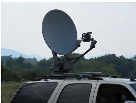
La station **DriveSat™ AP850** est un ensemble transportable spécialement conçu pour les applications Multimédia et SNG par satellite. Cette station est particulièrement étudiée pour opérer sur le satellite **KA SAT**.
